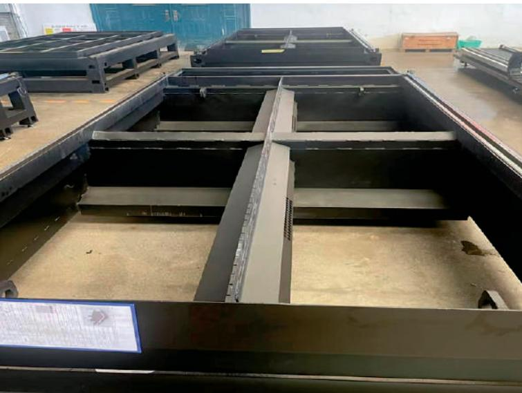
Наши станки лазерной резки имеют цельнометаллическую сварную станину, с высокой прочностью. При производстве, станина станка проходит термическую обработку для снятия напряжения металла. Благодаря этому удается добиться жесткости конструкции, а вследствие чего и безупречной точности обработки.
