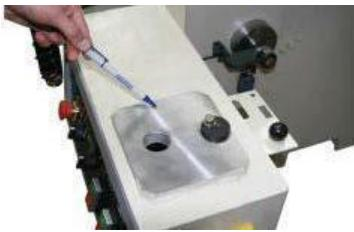
Широкие базовые поверхности станины, обработанные за один установ на порталном обрабатывающем центре, позволяют легко установить на них каретку. Данная конструкция не требует регулировки относительно основного стола, а также, облегчает монтаж и не требует дополнительных регулировок в дальнейшем.
